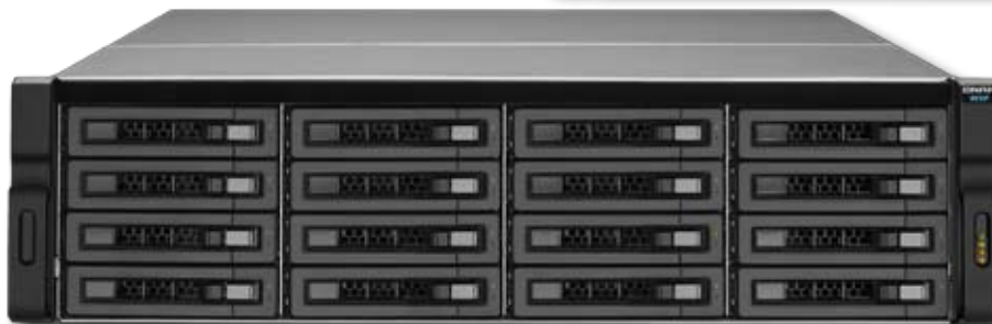
Модуль расширения QNAP REXP-1600U-RP служит для увеличения объема хранилища в системе Turbo NAS и поддерживает максимальную емкость свыше 400 Тб благодаря возможности объединения двух и более модулей посредством высокоскоростных кабелей мини-SAS. Особенно он будет полезен при работе с большими объемами данных, например, при обслуживании систем видеонаблюдения, телевидения и архивирования данных.
