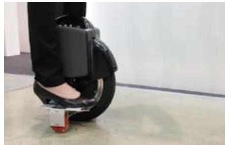
просто наклониться в нужную сторону. TOPJOY Pinwheel разгоняется до 22 км/ч, а заряда съемного аккумулятора достаточно для четырех часов автономной работы. Более того, на корпусе аккумулятора имеется разъем USB для подзарядки ваших гаджетов.
