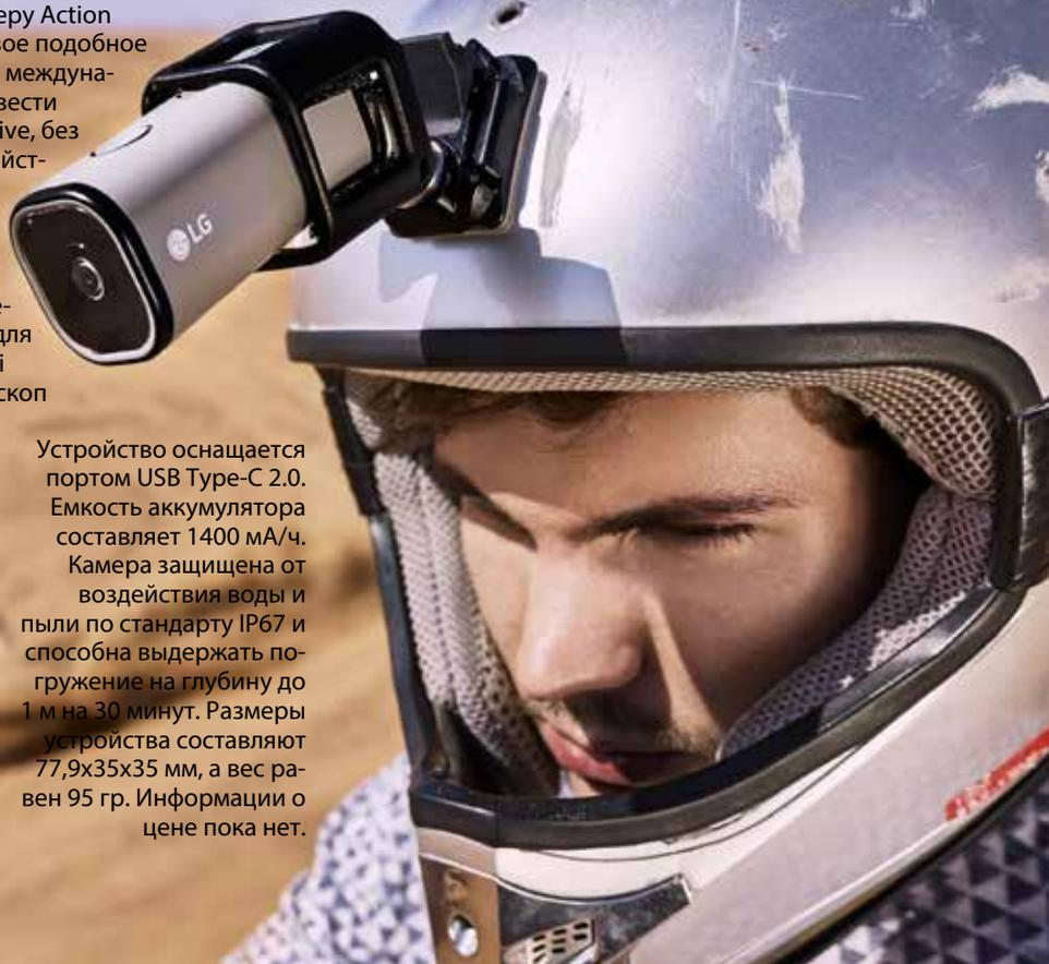
Устройство оснащается портом USB Type-C 2.0. Емкость аккумулятора составляет 1400 мА/ч. Камера защищена от воздействия воды и пыли по стандарту IP67 и способна выдержать погружение на глубину до 1 м на 30 минут. Размеры устройства составляют 77,9x35x35 мм, а вес равен 95 гр. Информации о цене пока нет.
