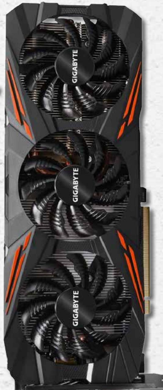
**В** этой ценовой категории лучшей видеокартой можно считать GIGABYTE GeForce GTX 1070 G1 Gaming 8G. Если у референсной видеокарты с графическим процессором GTX 1070 последний прогревается до 78°C под максимальной нагрузкой, то система охлаждения WINDFORCE 3X от компании Gigabyte обеспечивает ядру более щадящие условия работы. При этом владелец такой кастомной модели получает дополнительный бонус в виде меньшего уровня шума. Обратной стороной комфорта являются значительные размеры видео-
