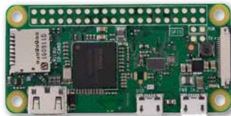
приобрести плату с поддержкой беспроводных интерфейсов Wi-Fi 802.11 b/g/n и Bluetooth 4.0. Raspberry Pi Zero W процессор Broadcom BCM2835 (ядро ARM11 1 GHz), 512 Mb оперативной памяти LPDDR2, слот для карт памяти формата microSD, разъемы mini-HDMI и Micro-USB. Кроме того, Raspberry предлагает готовые корпуса для Raspberry Pi Zero W с тремя сменными панелями.
