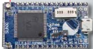
V3s обычно используется в видеорегистраторах, имеет всего 64 Mb оперативной памяти, одноплатный процессор ARM Cortex-A7, графический процессор ARM Mali-400 и поддерживает работу с Linux. У LicheePi Zero имеется слот microSD. Компьютер можно подсоединить к монитору или телевизору, а также к камере. Размеры новинки составляют 44,6x25,5 мм.
