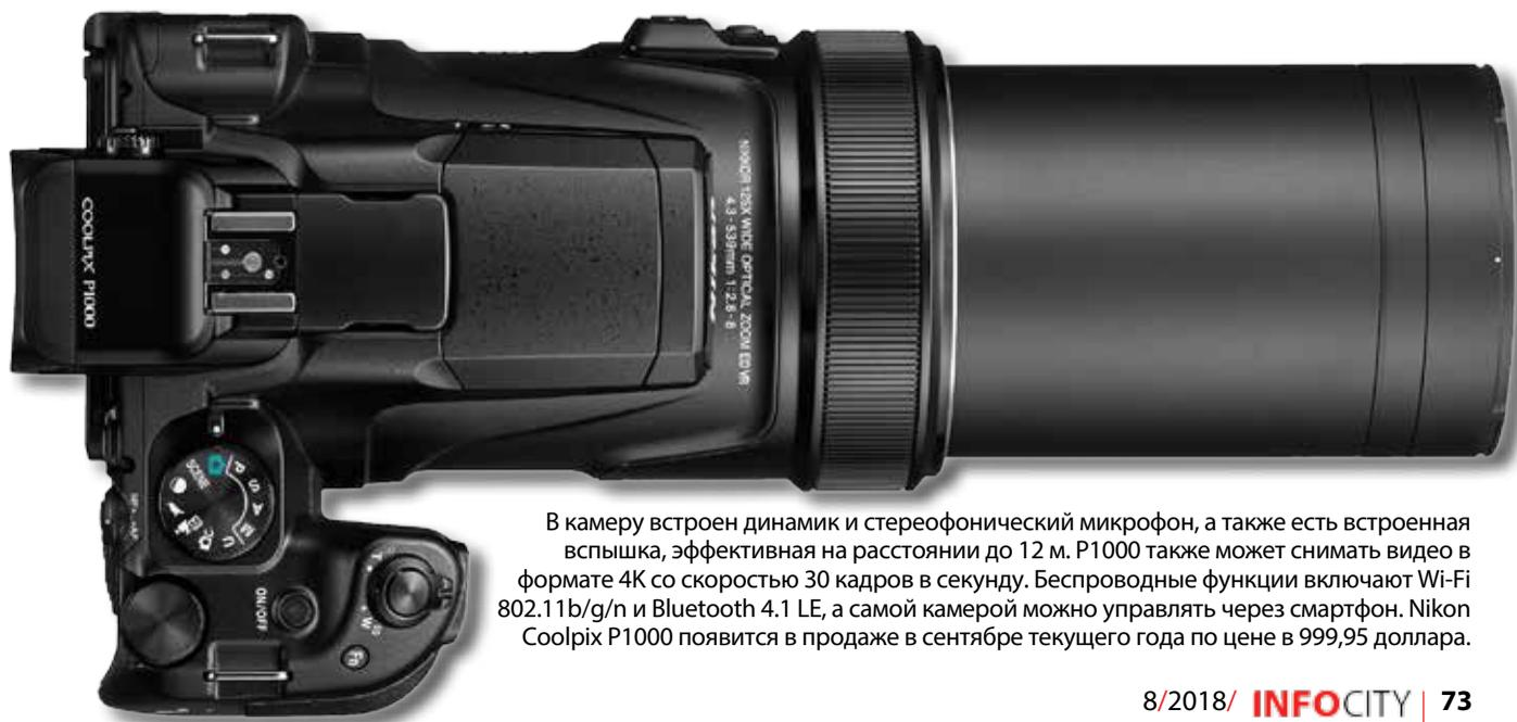
В камеру встроен динамик и стереофонический микрофон, а также есть встроенная вспышка, эффективная на расстоянии до 12 м. P1000 также может снимать видео в формате 4K со скоростью 30 кадров в секунду. Беспроводные функции включают Wi-Fi 802.11b/g/n и Bluetooth 4.1 LE, а самой камерой можно управлять через смартфон. Nikon Coolpix P1000 появится в продаже в сентябре текущего года по цене в 999,95 доллара.
