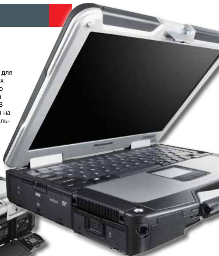
Оснащение включает модуль LTE для работы в сетях четвертого поколения, гигабитный сетевой контроллер, адаптер беспроводной связи Wi-Fi 802.11ac, контроллер Bluetooth, порты USB 3.0, HDMI, D-Sub и т.д. Ноутбук работает под управлением операционной системы Windows 10 Pro. Цена Panasonic Toughbook 31 стартует от 3700 долларов.
