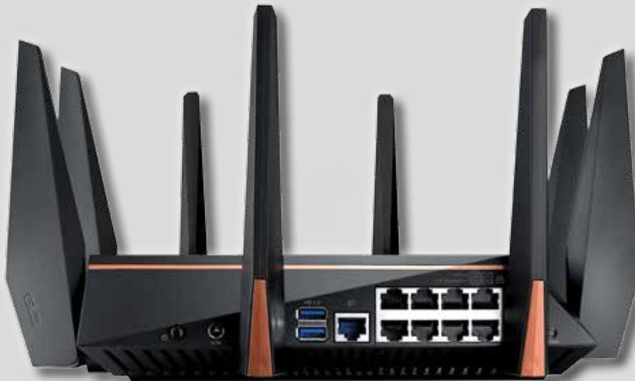
центре квартиры, что поможет добиться наиболее равномерного покрытия, или же установив в одной из дальних комнат репитер, который подхватит соединение и пробросит его дальше. Наконец, можно создать дополнительную сеть Wi-Fi на частоте 2,4 GHz. Скорость у нее будет меньше, зато радиус действия заметно увеличится.
