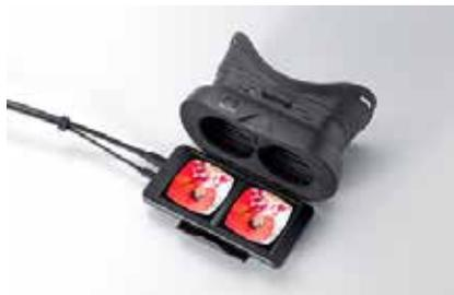
управлением операционной системы Windows 10. Другим преимуществом гарнитуры VRM-100 для бизнес-использования компания называет возможность отсоединять дисплей для его очистки. Размеры гарнитуры составляют 175x98x116 мм, а вес равен 336 гр.
