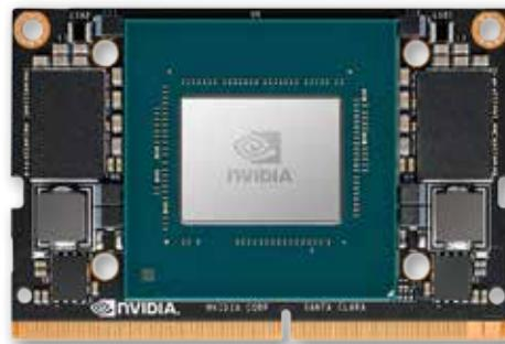
гопотребление в 15 W, этот модуль обеспечивает производительность на уровне до 21 тераоперации/с (Топс). Благодаря инженерным разработкам NVIDIA, Jetson Xavier NX обеспечивает производительность в 15 раз большую, чем Jetson TX2 с тем же энергопотреблением. Jetson Xavier NX работает на программной архитектуре CUDA-X AI и поддерживает комплект разработки NVIDIA JetPack, представляющий собой полный программный стек искусственного интеллекта.
