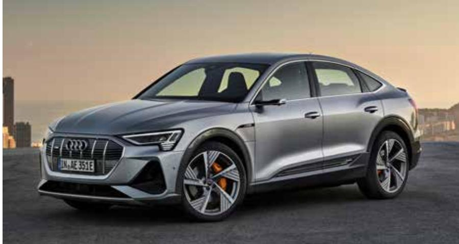
ми фарами с системой микрзеркал. С помощью электростатических полей почти миллион отражающих элементов (каждый имеет размер всего несколько сотых миллиметра) может менять положение с частотой до 5000 раз в секунду, позволяя очень точно регулировать световой пучок и даже проецировать различные изображения или анимацию на дорогу или стены. Электрокар будет предлагать-
