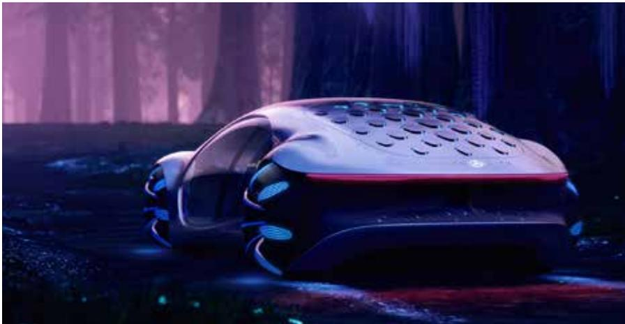
новлялись фильмом «Аватар» Джеймса Кэмерона, а режиссер даже присутствовал на презентации. Mercedes-Benz Vision AVTR может двигаться не только прямо, но и вбок благодаря сферическим колесам. Автомобиль оснащен прозрачными дверьми, которые позволяют пользователям приблизиться
