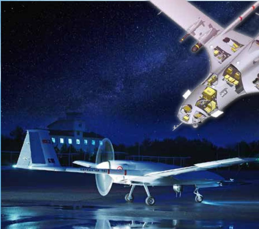
командный пункт контролирует до шести БПЛА Anka-S, а управление осуществляется по защищенному спутниковому каналу, что позволяет использовать аппараты даже в условиях радиоэлектронной борьбы со стороны противника. Дроны способны перемещаться по запрограммированным «контрольным точкам», взлетать и садиться в автономном режиме, а в случае потери связи совершать автономную посадку в заранее заданном месте. В ходе опера-
