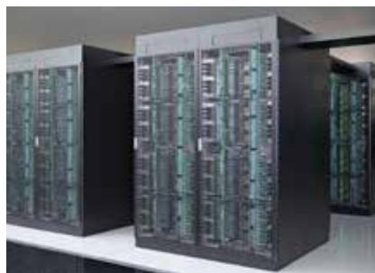
заключается одна из особенностей японской машины, поскольку фактически все существующие в мире подобные вычислительные гиганты базируются на процессорах, которые изначально предназначены для стационарных устройств. Операционная система Fugaku включает одновременно два работающих ядра операционных систем Linux и McKernel. Fugaku способен производить больше 415 квадриллионов операций за одну секунду, и этим он в 2,8 раза превосходит IBM Summit, который занял второе место рейтинга.
