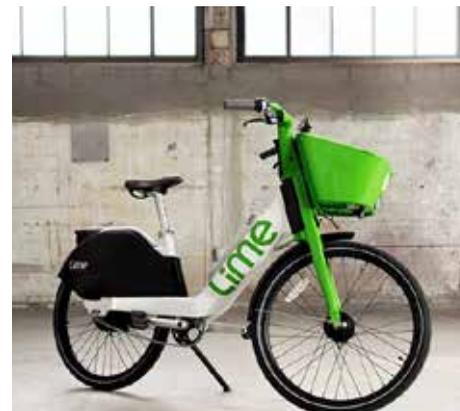
Новая модель будет оснащена более мощным двигателем 350 W и заменяемым аккумулятором, способным обеспечить запас хода до 40 км. Двухскоростной переключатель передач поможет при подъемах на холмы, а встроенная блокировка ступицы с электронным управлением поможет защитить байк от кражи. При весе в 32 кг велосипед сможет развивать скорость до 32 км/ч.
