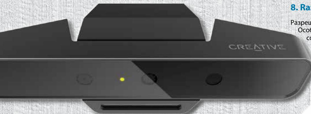
ектор. В процессе захвата визуальных данных эти три объектива управляются технологией Intel RealSense, чтобы реагировать на выражения вашего лица и движения тела.
