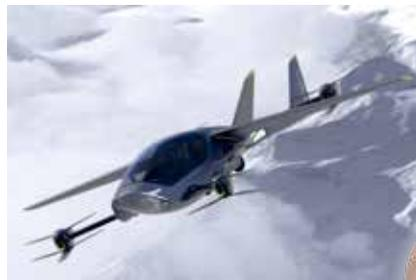
значенный для личного пользования. Это аппарат с неподвижным крылом, рассчитанный на двух человек. Оба пассажира будут иметь доступ к системе управления самолетом, что позволит вести совместное пилотирование. Самолет приводится в движе-
