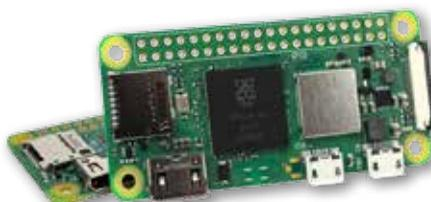
ми задачами этот одноплатный компьютер будет почти в 5 раз быстрее. Также он отмечает, что за отвод тепла отвечают толстые внутренние слои меди на плате. Новинка по-прежнему имеет 512 Mb оперативной памяти, модули Wi-Fi 802.11b/g/n и Bluetooth 4.2, один порт mini HDMI, а также два порта micro-USB и слот для карт памяти формата microSD.
