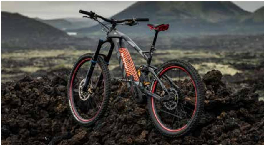
двигатель Brose S-MAG мощностью 250 W, который дает 4 уровня помощи педали и крутящий момент 90 Нм. Также имеется 12-ступенчатая механическая трансмиссия SRAM GX Eagle для разных режимов езды. Нижняя труба с маркировкой e-tron выступает в роли своеобразного чехла для аккумуляторной батареи Fantic Integra емкостью 720 Вт ч. Цена новинки стартует от 10000 долларов.
