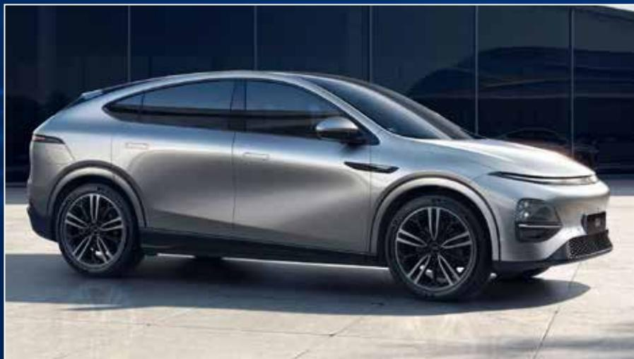
2.0 обеспечит ей высокую жесткость кузова на кручение в сочетании с уменьшенной за счет использования алюминиевых элементов массой. На одном заряде G6 способен проехать до 750 км, а его бортовая сеть рассчитана на напряжение 800 W. Приборная панель электромобиля включает 15" дисплей.
