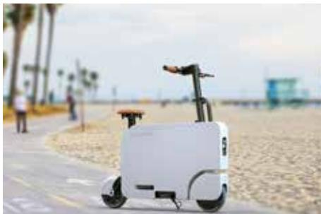
дах прошлого века. В неактивном виде транспортное средство напоминает настольный конвектор, однако стоит выдвинуть руль, сиденье и заднее колесо, как оно превращается в полноценный скутер, способный разогнаться до 25 км/ч. Заряда аккумулятора хватает максимум на 20 километров, а заряжается
