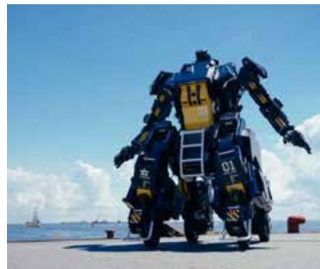
манипуляторами ARCHAX с помощью набора джойстиков. Отмечается, что максимальная скорость трансформера составляет 10 км/ч. Переходя в режим «транспортного средства», передние и задние колеса робота сдвигаются вперед и назад соответственно, а кресло пилота отклоняется на 17° для сохранения вертикального положения. Команда стартапа надеется продать 5 таких роботов по цене в 3 млн. долларов.
