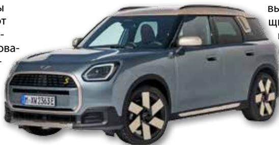
км/ч. Запас хода этой модели составляет 433 км. Производитель также отмечает, что несмотря на не слишком обтекаемую форму, коэффициент лобового сопротивления снижен с 0,31 до 0,26. Остается добавить, что интерьер электромобиля включает круглый 9,4" дисплей, который сочетает в себе информационно-развлекательную систему с новым персональным помощником и спидометром.
