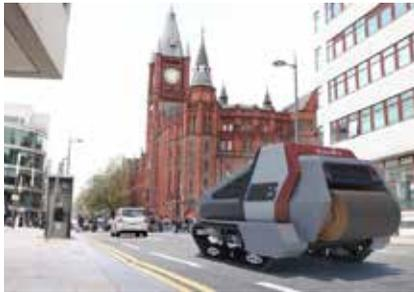
вание выбоин на дороге. ARRES Prevent вскоре приступит к своим первым работам на улицах общего назначения. Оснащенная искусственным интеллектом автономная система ремонта дорог ARRES Prevent самостоятельно патрулирует дороги, выявляя и заделывая трещины до того, как они превратятся в выбоины. Такой упреждающий подход значительно сокращает необходимость
