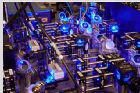
заявлениям Atom Computing, способны сохранять состояние до 40 секунд. А это открывает новые возможности в плане организации квантовых вычислений. Кроме того, можно обнаруживать ошибки, не нарушая работу других кубитов, а также исправлять их в реальном времени. Система использует состояние ядерного спина атомов Стронция-87 для представления состояний нуля и единицы для кубита.
