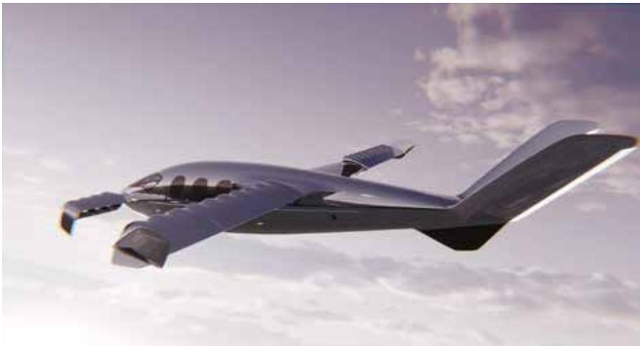
высоту, они переходят в горизонтальное положение. Крейсерская скорость CEO Jet составляет 515 км/ч. Самолет способен подниматься на высоту 6400 м. Но главной особенностью разработки Sirius Aviation и BMW Designwork стала водородная система, включающая топливный бак с жидким водородом. Для страховки CEO Jet оснащен дополнительным аккумуляторным блоком, рассчитанным на 90 секунд полета и способным перезарядиться во время полета. Серийное производство электросамолета запланировано на 2028 год.
