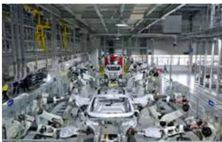
ного интеллекта. Фабрика оснащена более чем 40 цифровыми технологиями, включая технологию цифровых двойников, что позволяет в реальном времени отслеживать каждый этап сборки. Завод способен производить разные модели на одной линии и поддерживает свыше тысячи вариантов персонализации, включая разные силовые установки. Для контроля качества используется 369 систем наблюдения и 26 проверочных зон, а в 73 рабочих точках используются системы визуального контроля на базе искусственного интеллекта.
