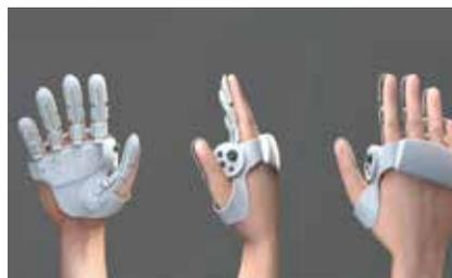
стиками и кнопками для управления в виртуальной среде. Как отмечает производитель, можно создавать собственные тактильные скрипты без навыков программирования. Также в Sharp предупреждают о технических ограничениях. Прототип, например, не передает силовую обратную связь (твердость/мягкость) и температурные ощущения, а также не поддерживает точное отслеживание пальцев, как это делают VR-перчатки. Сейчас проект находится на экспериментальной стадии разработки.
