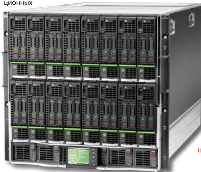
Охлаждение сделано резервированным и зонированным, чтобы обеспечивать наибольший воздушный поток именно для тех лезвий, которым это необходимо, а не перерасходовать электроэнергию и ресурс вентиляторов бесцельно. Питание шасси может получать от однофазного (220
