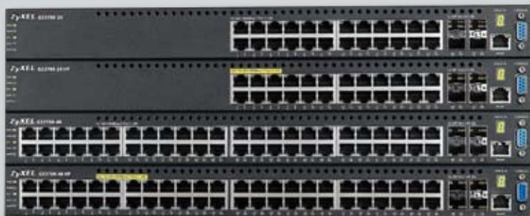
Коммутатор XS3900-48 предназначен для соединения серверов в ЦОД на скоростях 10 Gbit/s и 40 Gbit/s
