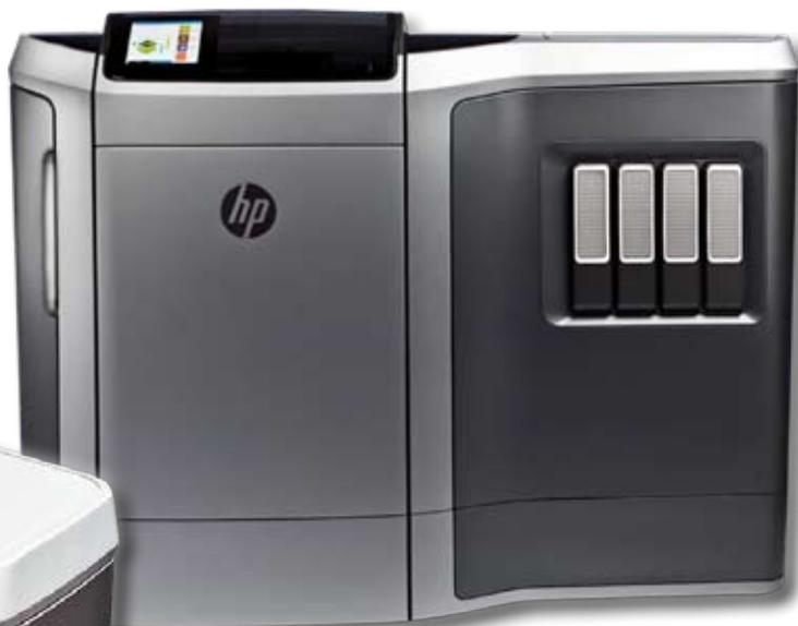
В частности, система будет иметь разрешение 1200 точек на дюйм. В числе прочих преимуществ Multi Jet Fusion - более совершенная репродукция цветов и большая прочность получаемых продуктов. В HP надеются начать продажи первых 3D-принтеров с технологией Multi Jet Fusion в 2016 году, однако предполагается, что подобные разработки будут предназначены для производства и бизнеса, а не для домашнего использования.
