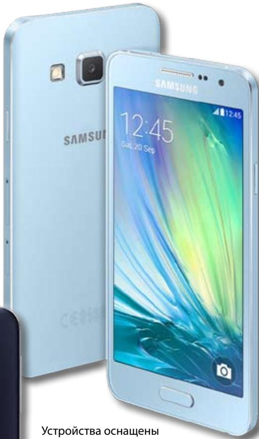
Устройства оснащены 5 Мр фронтальными камерами и работают в сетях 4G (LTE). Samsung Galaxy A5 базируется на 1,2 GHz четырехъядерном процессоре, имеет 1 Gb оперативной и 16 Gb встроенной памяти, а также аккумулятор емкостью 2300 мА/ч. Характеристики Samsung Galaxy A3 также включают 1,2 GHz четырехъядерный процессор, 2 Gb оперативной и 16 Gb встроенной памяти, а также аккумулятор емкостью 1900 мА/ч. Работают устройства под управлением операционной системы Android 4.4 KitKat.
